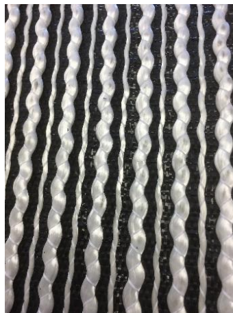
Figure 3. Géosynthétique « bi-raideur inversée » avec les deux raideurs en traction.
