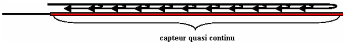
Figure 4. Schéma de principe des capteurs à diffusion Brillouin le long d'une fibre optique.
