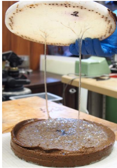
Figure 3. Photographie d'une éprouvette de l'échantillon GSB3 NaPoly-P avec l'illustration du liquide gélatineux
